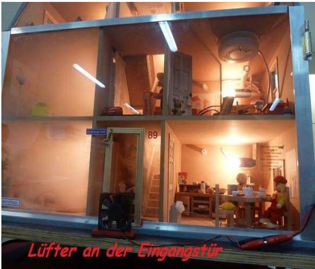
Ein **Druckbelüfter**, auch **Hochdruck(be)lüfter** oder **Überdruckbelüfter** genannt, ist ein feuerwehrtechnisches Gerät, das eingesetzt wird, um verqualmte Räume oder Häuser rauchfrei zu machen oder nicht verqualmte Gebäudeteile rauchfrei zu halten.
